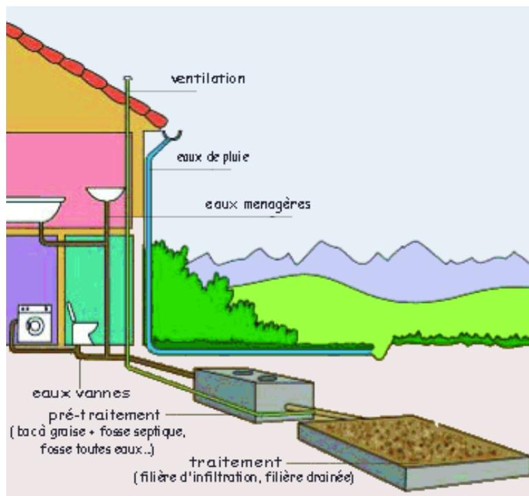
A noter que la pose d'ouvrages d'assainissement est règlementairement interdite dans un rayon de 35.00 mètres autour d'un puit, forage ou source dont l'eau est employée à des fins domestiques (boisson, bain, vaisselle, arrosage potager, ...) et dont l'usage a été déclaré en mairie.
